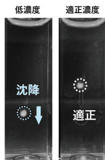
図1. 増粘剤濃度による液滴位置変化(12時間後)
