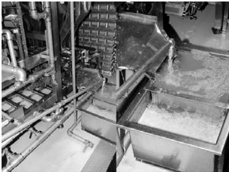
図1. うどん冷却・洗浄プロセス（左）とうどん排水（右）
