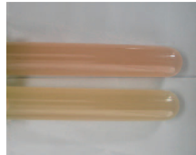
図6. As-CrtIBS の亜ヒ酸に対する色調変化。下, 亜ヒ酸非添加; 上, 50 \mu\text{g/l} As (III) 添加。
