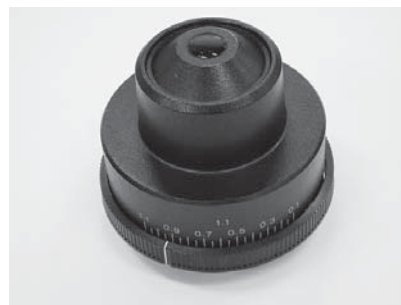
図6. コンデンサの開口絞り環と目盛
