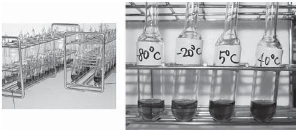
図8. DH-Indoleを主成分とする「メラニン前駆体溶液」の保存試験. ガラス製アンプルに溶液1mlを入れ窒素を封入した.
