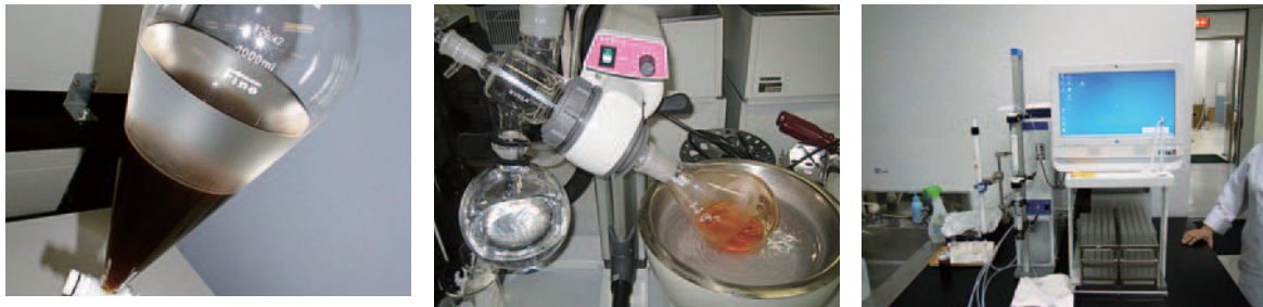
図6. 抗生物質の抽出と精製の流れ. 左から, 液・液分配→エバポレーター(濃縮)→シリカゲルCC
