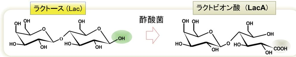
図1. ラクトビオン酸の発酵製造プロセス
