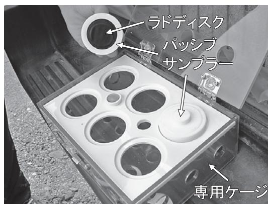
図7. ラドディスクを固定したパッシブサンプラーとパッシブサンプラーを設置するための専用ケージ
