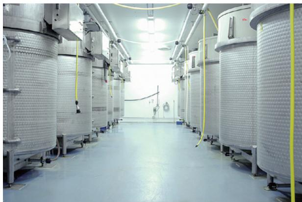
図5. 屋内密閉タンクによるヘマトコッカスの培養 (Asta Real AB社 (スウェーデン))
