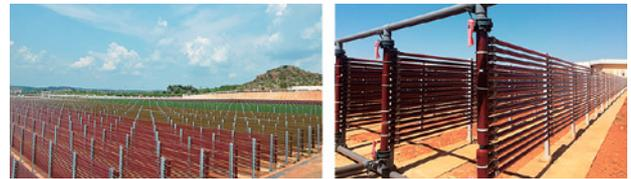
図4. チューブラー型のヘマトコッカス培養設備
