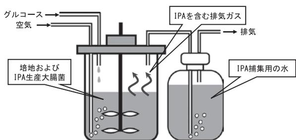
図3. IPA 培養システム模式図. 発酵槽内で発生した排気ガス (IPA を含む) を捕集用水にバブリングさせ、IPA を捕集する。
