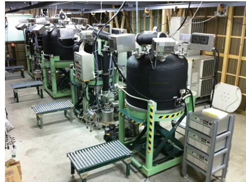
図4. 減圧調整式マイクロ波水蒸気蒸留装置の写真
