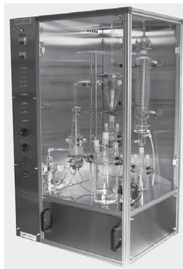
図2. ラボ用超音波霧化分離装置第一号
