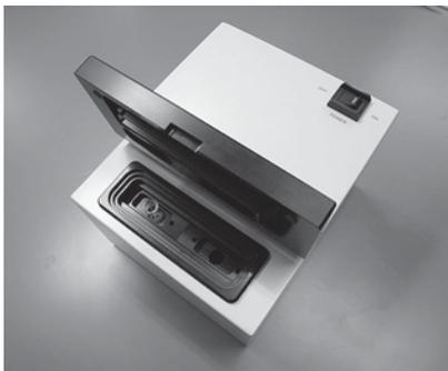
図2. 食細胞食食能評価用試作機。チューブ型2連。
