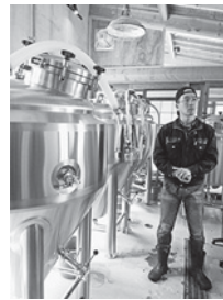
左：醸造タンク（製造タンク3基、仕込み1回あたり350L製造、年間生産量およそ10kL）。右：醸造所はRISE & WIN併設ブリュワリーに併設
