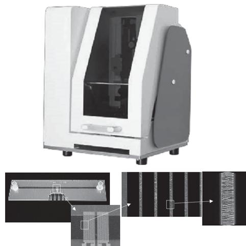
図2. 微生物迅速検査システム「エレスト™」およびマイクロ電極（マイクロ流路内）に捕捉された微生物。
