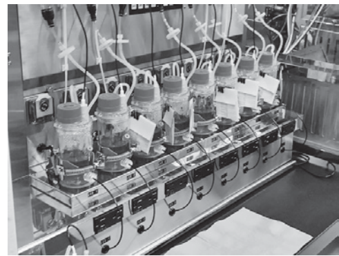
図2. ヒトiPS細胞用3次元浮遊攪拌懸濁培養装（8連装置）
