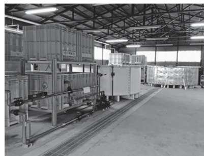
図2. 研究用循環式陸上養殖設備
