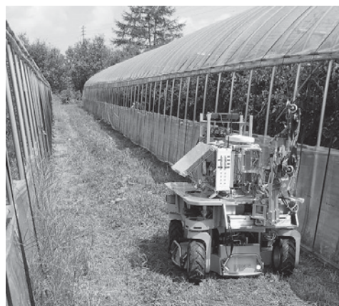
画像とGPSを用いた自律除草ロボット開発のための予備実験(北大工学研究院・江丸提供)
