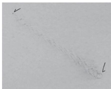
図5. エアロゲル中に捕集された粒子と突入時に生じたトラック(NN1A0183T)。焦点深度を変えて撮影した画像を重ね合わせて作成したので、多少、段差が生じている。右下矢印が粒子の突入口で、左上矢印に粒子が見える(写真提供：たんぼぼチーム)。
