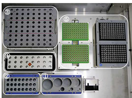
図4. GlycoAutoPrep™の試薬類、カラム、チューブ、チップのセット部。①：試薬ラック，②：チューブラック，③：カラムラック，④：ヒーター部分，⑤：チップラック。
