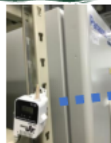
超低温庫に温度センサーとワイヤレスデータロガーを設置
